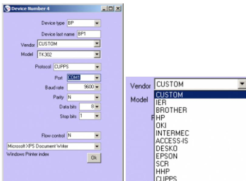
Il suffit de sélectionner un vendeur et un modèle parmi la liste des matériels certifiés CUPPS pour ajouter ou remplacer un périphérique (imprimante CAB ou TAG, Lecteur de passeport, de carte magnétique, de CAB, etc.).
