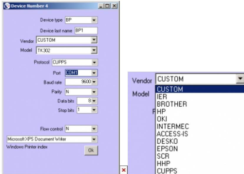
Il suffit de sélectionner un vendeur et un modèle parmi la liste des matériels certifiés CUPPS pour ajouter ou remplacer un périphérique (imprimante CAB ou TAG, Lecteur de passeport, de carte magnétique, de CAB, etc.).
