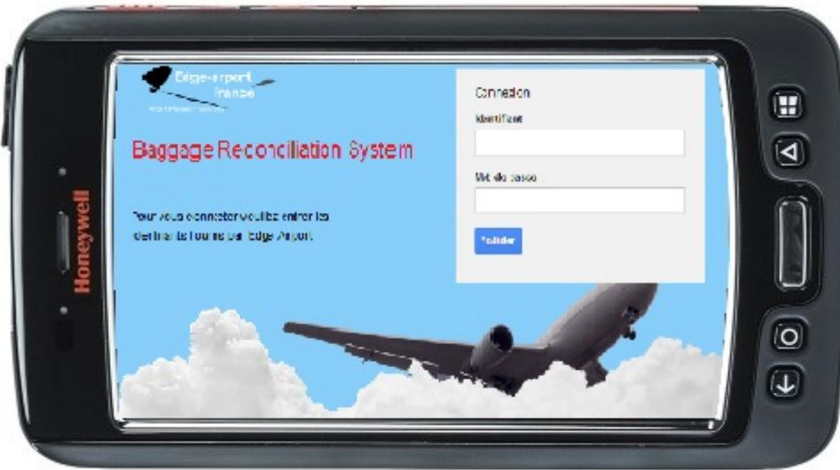
Grâce à l'utilisation de terminaux mobiles munis de scanners à codes à barres, les bagagistes ont accès aux informations en temps réel qui les aident à localiser des bagages, charger ou décharger des conteneurs (ULD, Unit Load Device), etc.
