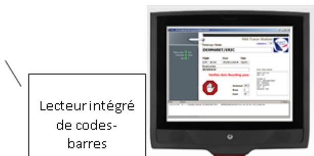
Il suffit de présenter la carte d'embarquement ou le smartphone du passager sous le lecteur intégré de code-barres et le système vérifie la validité du titre de transport.
