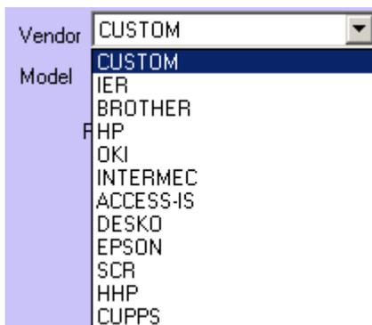
Il suffit de sélectionner un vendeur et un modèle parmi la liste des matériels certifiés CUPPS pour ajouter ou remplacer un périphérique (imprimante CAB ou TAG, Lecteur de passeport, de carte magnétique, de CAB, etc.).
